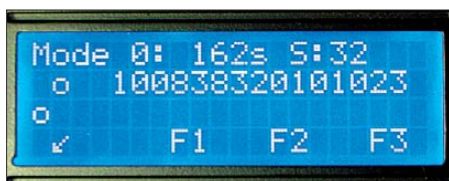
Bild 5: In dieser Anzeigevariante (Taste F2) ist der zeitliche Verlauf der empfangenen ASCII-Zeichen besser verfolgbar. Im Beispiel wurden zuerst am Pin 3 ein o und dann am Pin 2 ein o, gefolgt von 100838320101023, empfangen.
