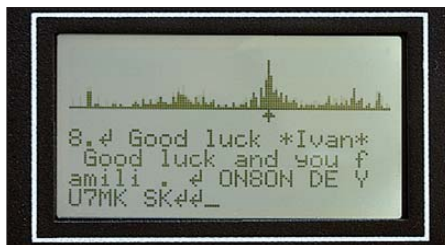
Bild 6: Anzeige während des Betriebs: Im oberen Teil sieht man das Empfangsspektrum, unten den Sende- bzw. Empfangstext. Unterhalb des Spektrums befindet sich ein Pfeil, der mit Tune oder den Pfeiltasten auf der PS/2-Tastatur nach links und rechts bewegt werden kann, um das gewünschte Signal auszuwählen. Fotos: DK3RED
