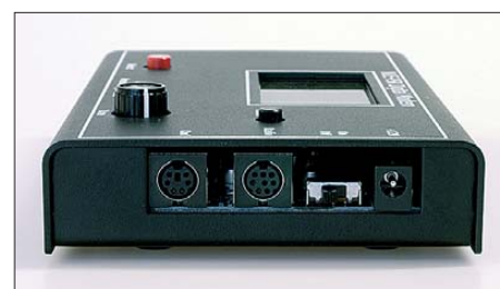
Bild 3: An der rechten Seite des Modems befinden sich die Anschlüsse für Stromversorgung, Transceiver und Tastatur sowie der Ein-/Aus-Schiebeschalter
