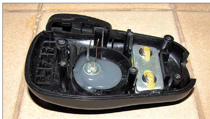
Bild 9: Um HF abzublocken, wird ein 1-nF-SMD-Kondensator direkt auf die Elektretkapsel gelötet.
