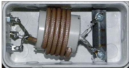
Bild 11: Die Speisedrossel aus Koaxialkabel lässt sich geschützt in einer Anschlussdose direkt am Speisepunkt unterbringen. Bis 250 W HF bietet sich dazu Teflon-Koaxialkabel RG188 auf einem 25-mm-PVC-Rohr an.
