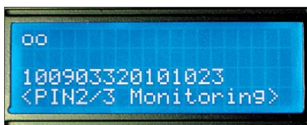
Bild 6: Nach Betätigung der Taste F3 werden alle ankommenden Zeichen ohne Richtungsunterscheidung angezeigt. Das ist eine Art Monitorfunktion.
