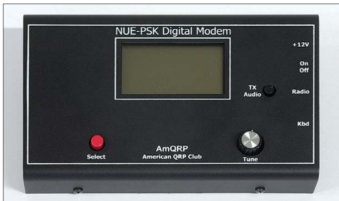
Bild 1: Auf der Frontseite des NUE-PSK Digital Modems befinden sich das Display und drei Bedienelemente.
