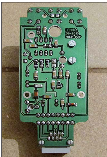
Bild 5: Bis auf ISD-Chip und Spannungsregler befinden sich alle SMD-Bauteile auf der Platinenunterseite.
