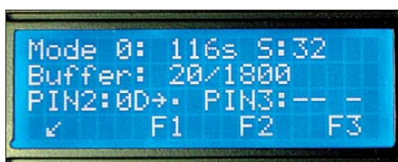
Bild 4: Anzeigevariante 1 (Taste F1); im Logger-Mode 0 wurde zuletzt am Pin 2 0DH empfangen. Im Puffer befinden sich bereits 20 Byte von 1800 möglichen. Das Statusbyte ist S:32, 116s die Zeit seit dem Start.
