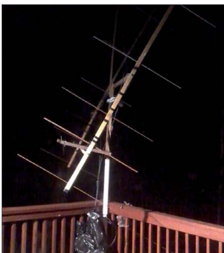
Mit weichen einfachsten Mitteln mittlerweile EME auf 2 m möglich ist, demonstriert Igor, AK4T: Auf Holzträgern hat er sich im US-Bundesstaat Georgia, Locator EM74VB, zwei vertikal polarisierte und horizontal gestockte 8-Element-Yagi-Antennen nach DK7ZB aufgebaut und das Standrohr am Balkonzahn montiert. Vom Balkon aus klappt es mit 400 W erfolgreich via Mond. Foto: AK4T
