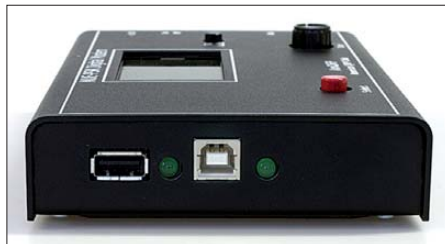
Bild 5: Wenn die USB-Platine eingebaut ist, findet man die beiden USB-Anschlüsse an der linken Seite des Modems.
