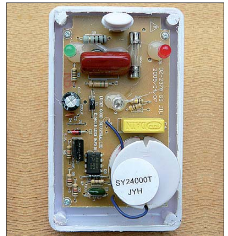
Bild 3: Innenansicht des Riddex Plus ; rechts unten befindet sich die Spule, links daneben der Thyristor und der Ansteuerschaltkreis. Das gelbe Bauteil über der Feldspule ist der Störerschutzkondensator. Fotos: DG9WF
