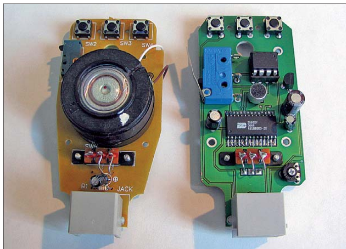
Bild 1: Die beiden Platinen zum Vergleich; links die Originalplatine des MH-31, rechts der Prototyp der Austauschplatine mit dem ISD 2560
